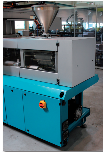
Der Blick auf die Schutzhaube zeigt, dass diese nicht mehr über das Maschinengestell hinausragt.
