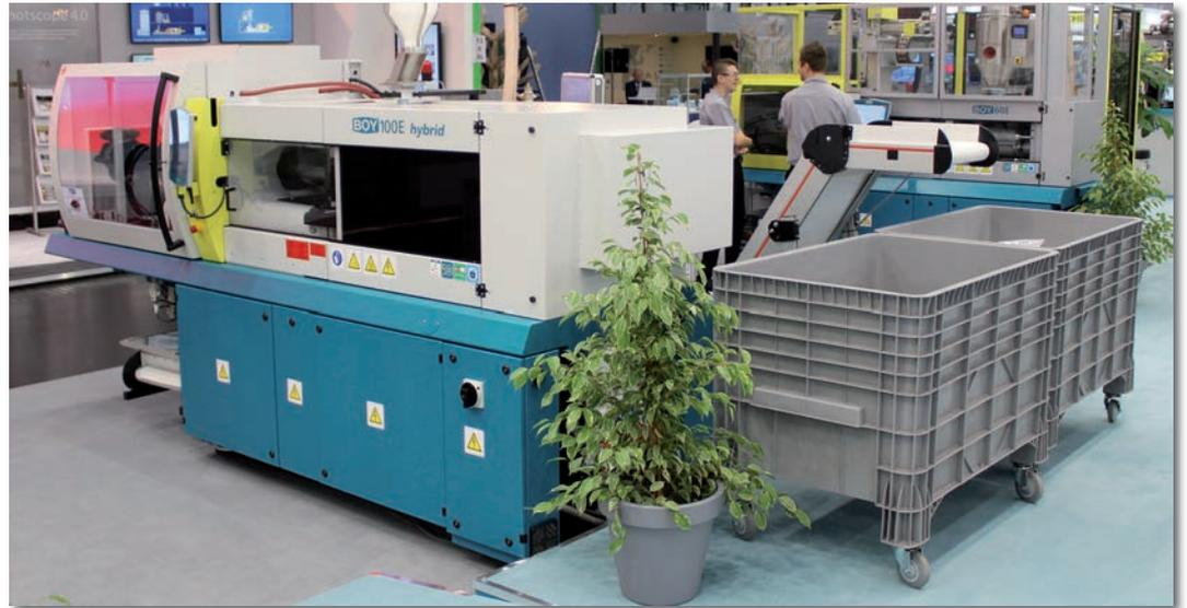
Optional jetzt auch hybrid: BOY-Spritzgießautomat mit elektromechanisch angetriebener Spritzeinheit
