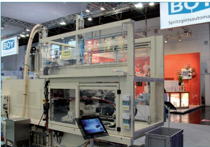
Eine Positionierung des Entnahmehandlings BOY LR 5 in Richtung der Maschinenachse bringt Platzvorteile durch Verzicht auf eine Umhausung
