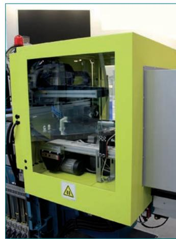
Vollständig unter der Schutzhaube der BOY 25 E integriertes Entnahmehandling und Förderband
